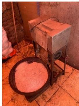
**Gambar 4** Mesin pamarut kelapa
