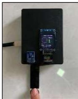
**Gambar 9.** Tampilan Alat Saat Sensor FSR ditekan
