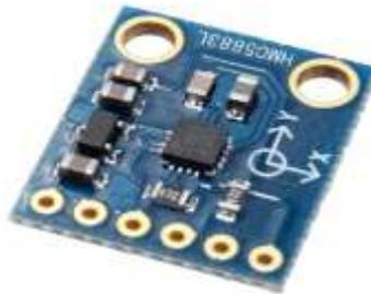
**Gambar 5.** Modul Kompas HMC5883L
